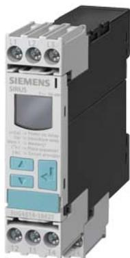
Цифровое реле контроля Асимметрия 0–20 % Подключаемое чередование фаз Выпадение фазы 3 x 160–690 В AC, 50–60 Гц Пониженное напряжение 160–690 В Гистерезис 1–20 В Задержка включения и отключения 0–20 с 2 переключающих контакта Винтовой зажим Продукт-преемник для 3UG3012-1A...
